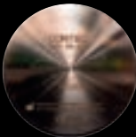
CoCr M6 disc molybdenum containing type 4 alloy (EN ISO 22674)
